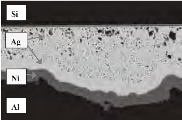
図 2 1 断面 SEM 像 高温放置 1000 時間後
