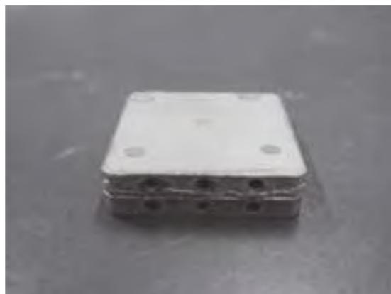
図1 熱抵抗評価用試験片
