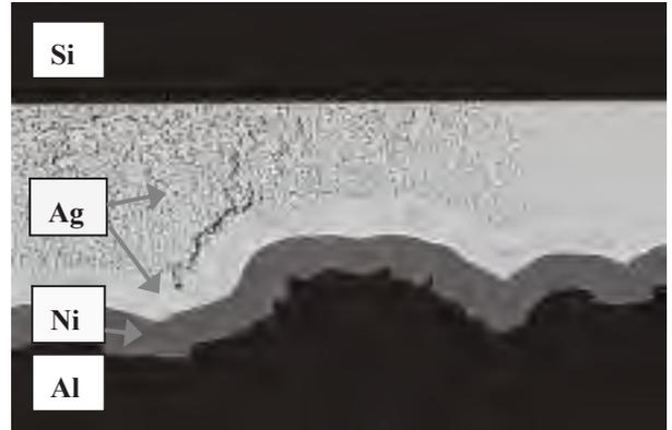
図 2 5 断面 SEM 像 温度サイクル 500 サイクル後
