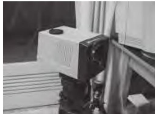
図 1 5 赤外線温度分布測定機の外観図
