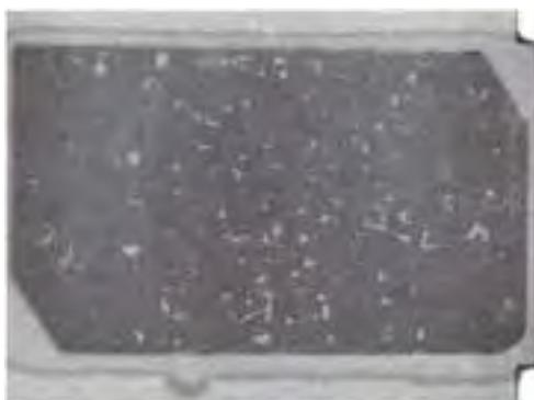
図5 真空中で接合したチップの X 線透過像
