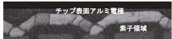
図8 チップ表面アルミ電極のEBSD観察結果
