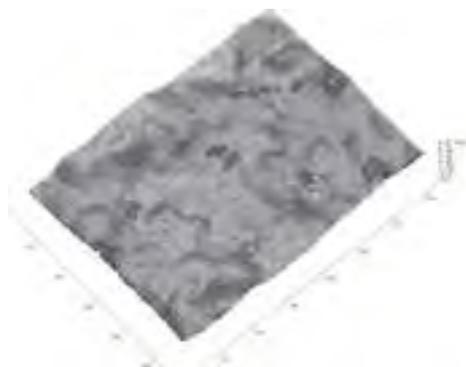
図4 スラリー塗布後の表面状態(超深度形状測定顕微鏡像)
