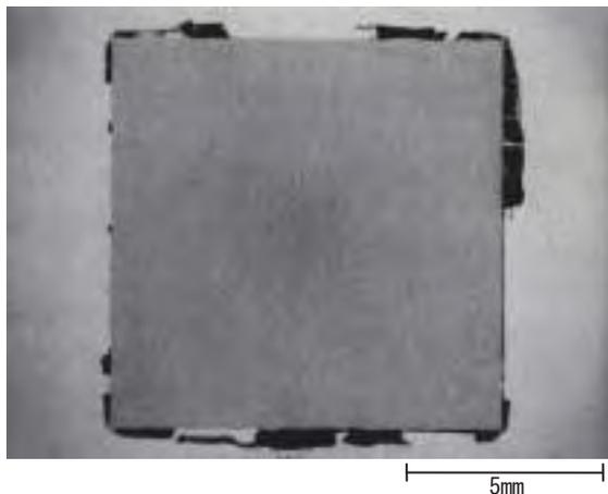
図16 接合部のX線透視像
